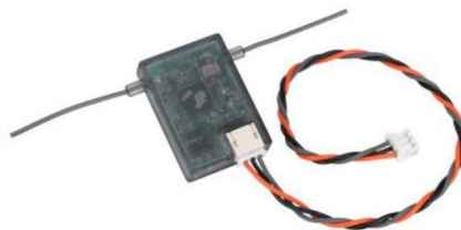
Abbildung 3.2: Spektrum Remote Receiver – Quelle: [Hor16, S. 2]
